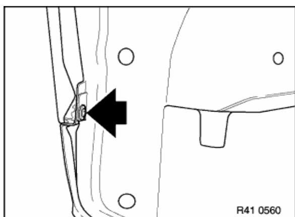
Schraube für Befestigung Verkleidung für Abdeckung am Längsträger und Seitenwand hinten lösen.
