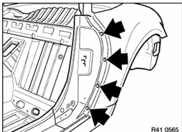
Befestigungsschrauben der Seitenwand hinten an der B-Säule lösen.
