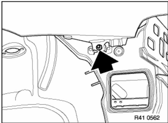
Schraube für Befestigung Seitenwand hinten an Radhaus hinten lösen.
