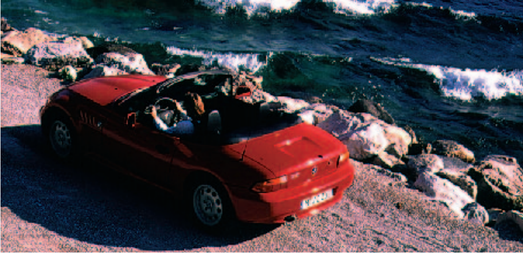
Der Rahmen der Windschutzscheibe dient als Überrollbügel
