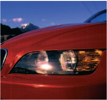
Gutes Fernlicht, schwaches Abblendlicht: Doppelscheinwerfer
