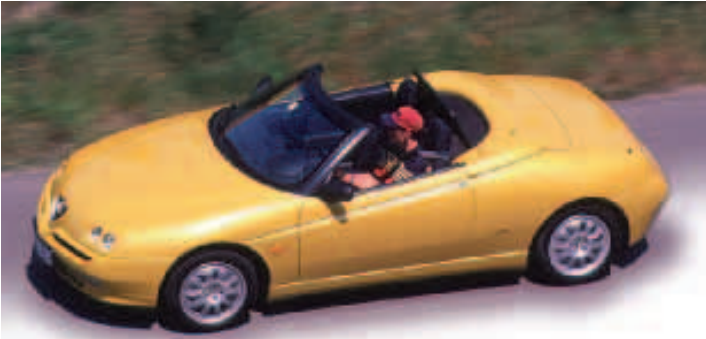
Der Alfa Spider zeigt eine stark ausgeprägte Keilform
