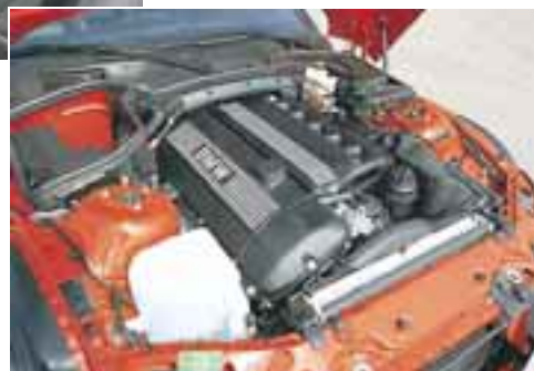
Nicht nur optisch ein Prachtstück: der Rei- hensechszylinder mit 2,8 Liter Hubraum
