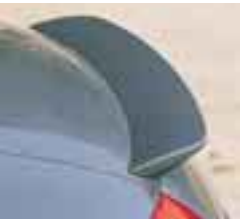
Bringt mehr Fahrstabilität bei hohem Tempo: neuer Spoiler auf dem Kofferraumdeckel
