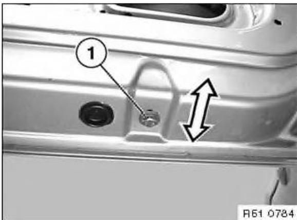
Schraube (1) lockern und Fensterführungsschiene (vorn) verschieben.
