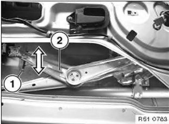
Durch Verstellen der Schraube (1) am Fensterheber (2) wird die Türfensterscheibe in der Höhe eingestellt.
