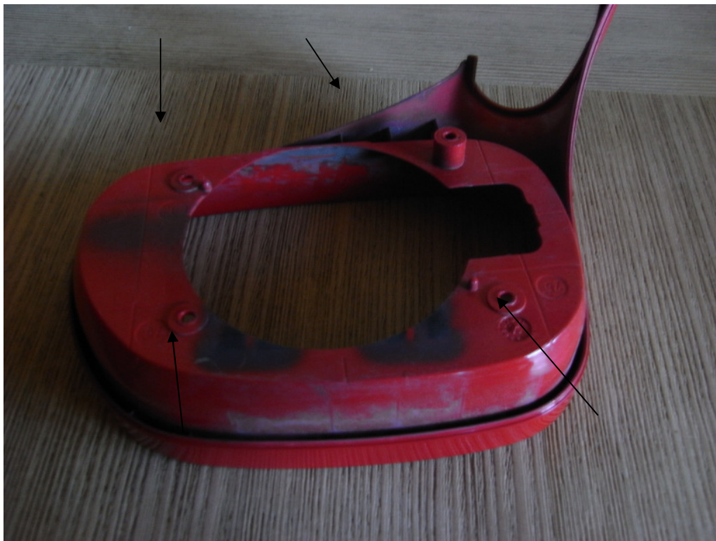
Vordere Spiegelgehäusehälfte mit den Löchern für die 4 Torx
