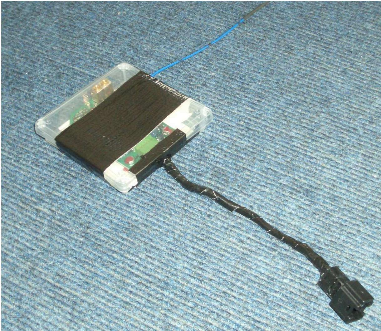
Hier hängt der Empfänger schon am Bordnetz. Die Innenbeleuchtung kann von der linken Seite her mit einem Schlitzschraubenzieher einfach ausgehebelt werden. Durch das entstehende Loch können wir den Empfänger hinter das Licht zwischen Dach und Himmel plazieren. Die Stelle ist wie dafür gemacht. Nun kann bereits ein erster Funktionstest erfolgen. Den Kabelbaum habe ich noch als Scheuerschutz und gegen Klappergeräusche mit einer Hülle aus 1 mm starkem Moosgummi versehen (noch nicht auf dem Bild).
