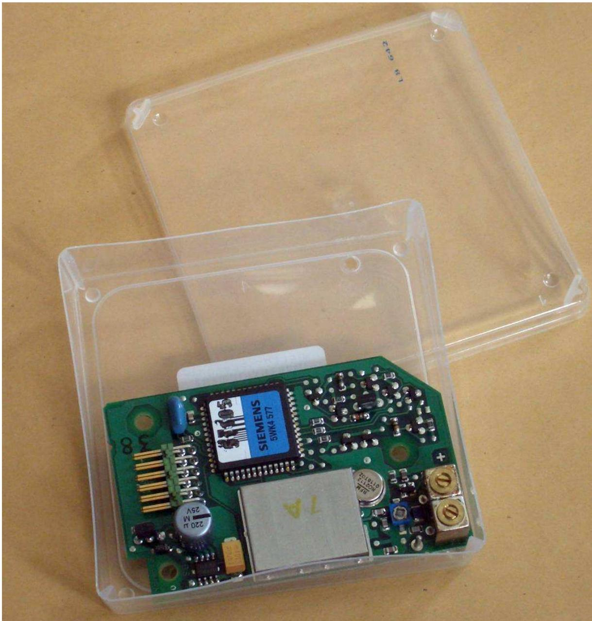
Um Höhe zu sparen wird die Antenne am Pin der Platine verlötet und aus Sicherheitsgründen das freie Ende mit einem Schumpfschlauch isoliert.
