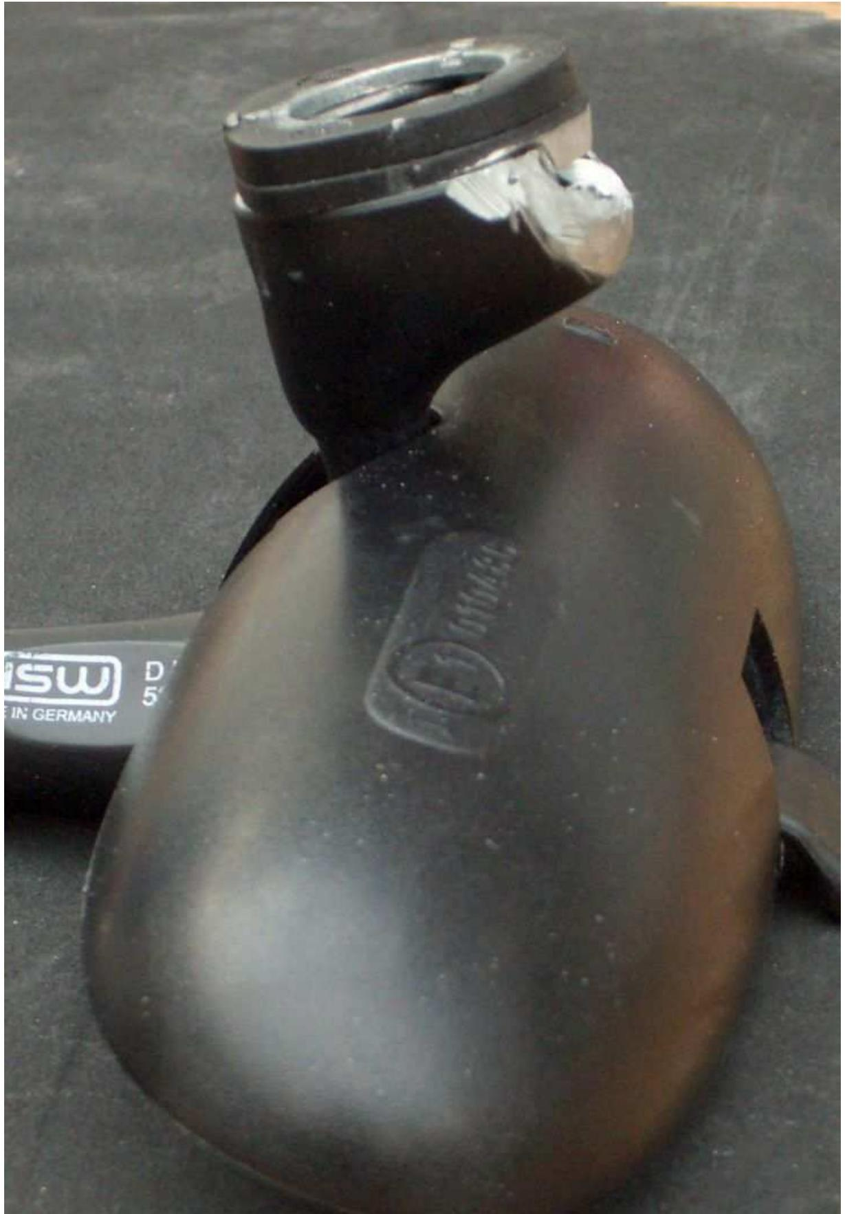
In der gezeigten Position habe ich die beiden Aluminiumstücke mit Sekundenkleber zusammengefügt.
