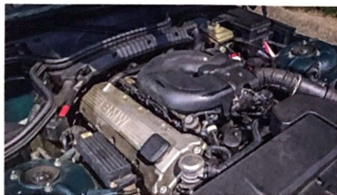
Die im Roadster verbauten Vierzylindermotoren besaßen 1,8 oder 1,9 Liter Hubraum
