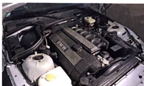
Der 2,8-Liter-Reihensechszylinder (192, später 193 PS) schmückte Roadster wie Coupé
