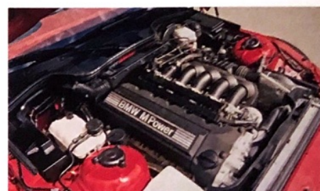
Die Krönung in Sachen Leistung bot der M-Motor mit 321 beziehungsweise 325 PS
