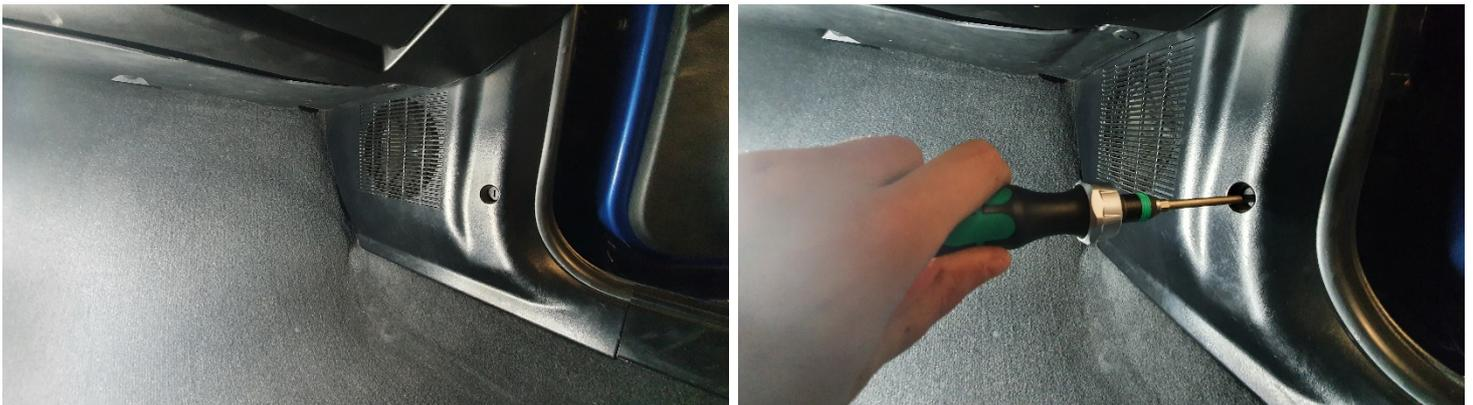
10. Demontage der Verkleidung unterhalb des Handschuhfachs, die drei (Mitte!!!) Klammern wie zuvor lösen.
