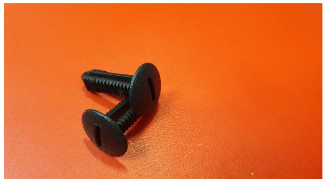
Beim Zusammenbau müssen diese Klammern nur wieder eingesteckt und durch eine 90-Grad-Drehung unter beständigem Druck wieder verriegelt.
