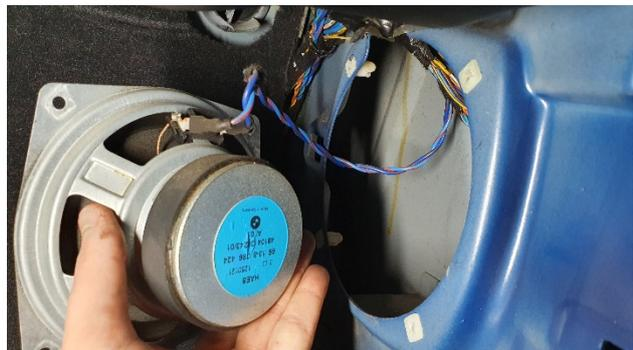
14. Jetzt kann der neue Lautsprecher eingebaut werden. Der Zusammenbau versteht sich in umgekehrter Reihenfolge des Ausbaus.
