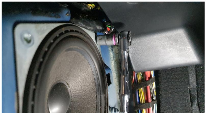
7. Der Lautsprecher ist nun lose und kann abgesteckt werden. Die Kabelschuhe sind durch die Größe codiert.
