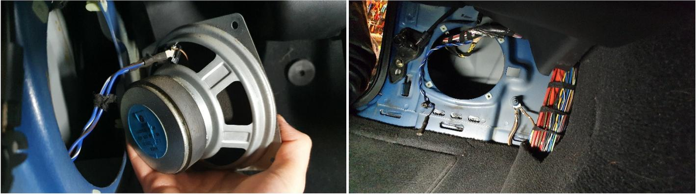
8. Jetzt kann der neue Lautsprecher eingebaut werden. Der Zusammenbau versteht sich in umgekehrter Reihenfolge des Ausbaus.
