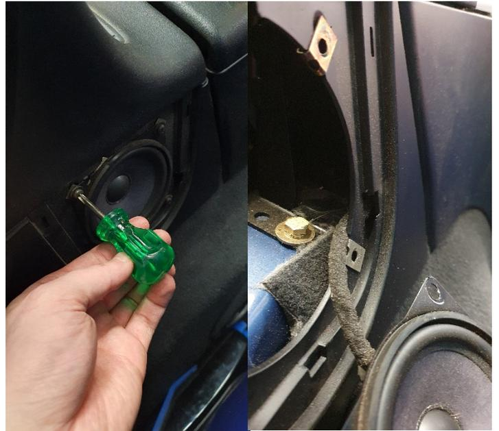
3. Die Lautsprecher sind im Bereich zwischen den Überrollbügeln am Audiokabelbaum angesteckt. (Bei Roadstern mit Ablagefach muss dieses ggf. zuvor ausgebaut werden, um an die Stecker zu gelangen!)
