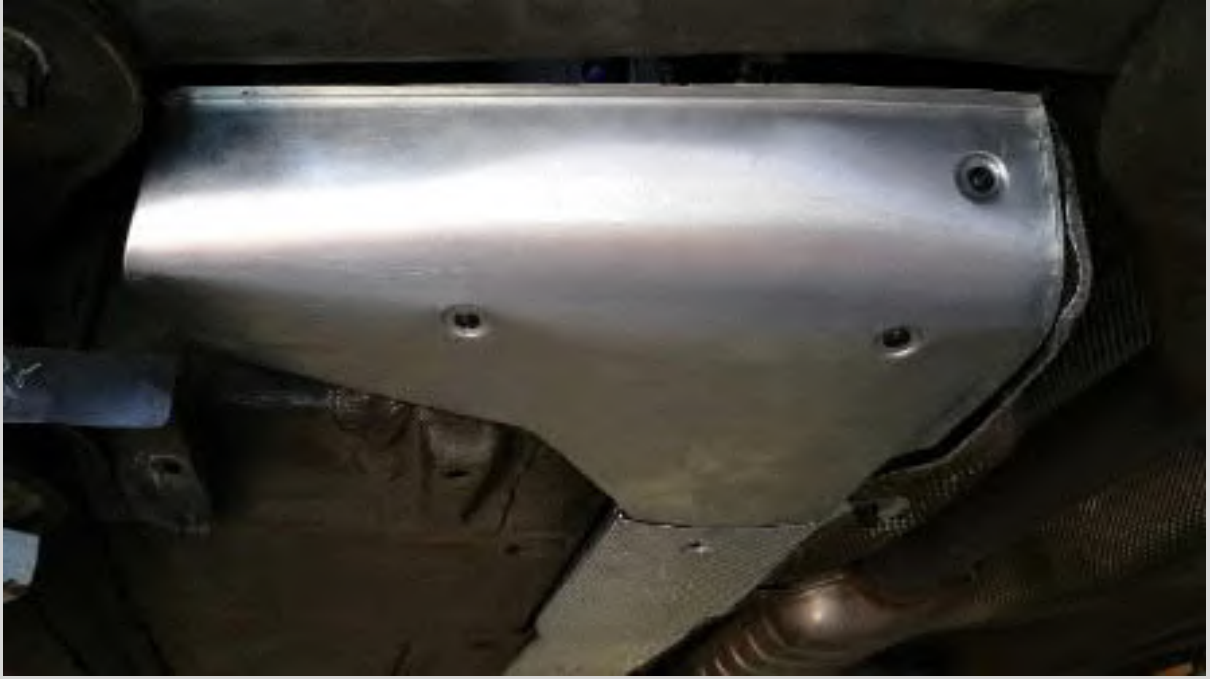
Letzte Anprobe vor dem Aufziehen der Strukturfolie.
