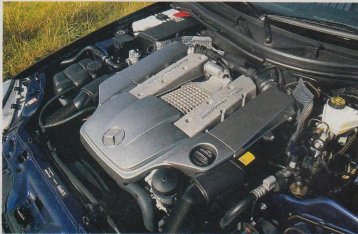
■ Eingerahmt: Zwischen den beiden Zylinderbänken findet der Schrauben- kompressor Platz, der dem V6 zu einer Leistung von 354 PS verhilft
