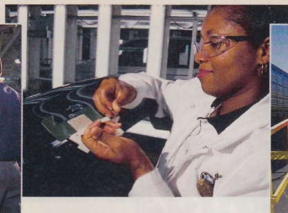
... drückt Daisy das Z3-Typenschild in vorge- stanzte Löcher. Nach ...
