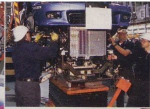
... unzähliger Einzelteile die Hochzeit zwischen Fahrwerk und ...
