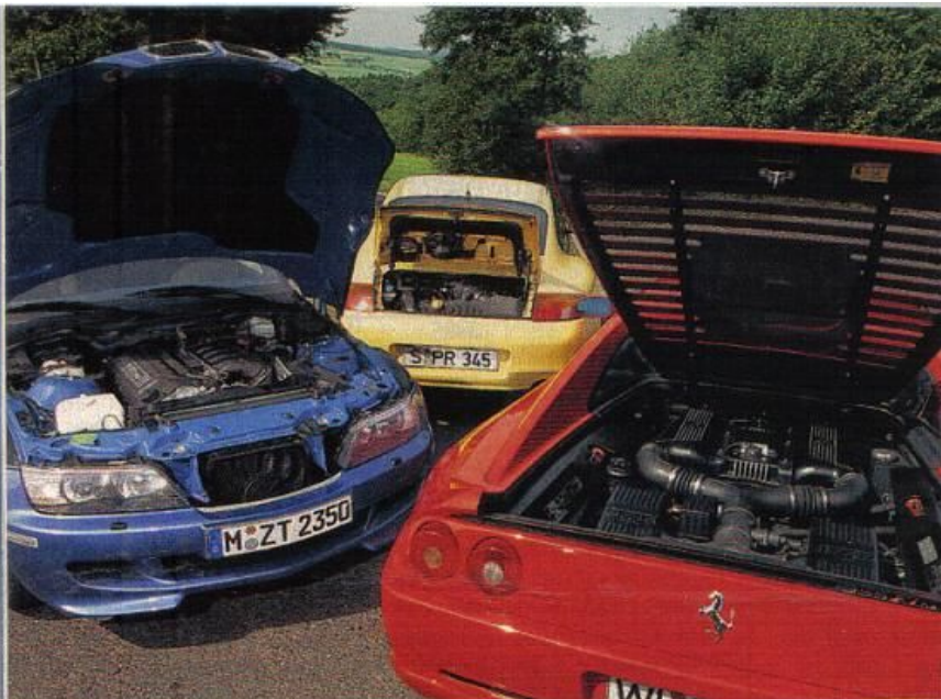
Antriebsvielfalt: Reihensechszylinder vorn (BMW), Mittel-motor-V8 (Ferrari), Sechszylinder-Boxer im Heck (Porsche)
