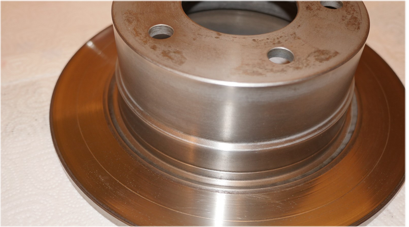
Nabe der Bremsscheibe kann auch lackiert werden
