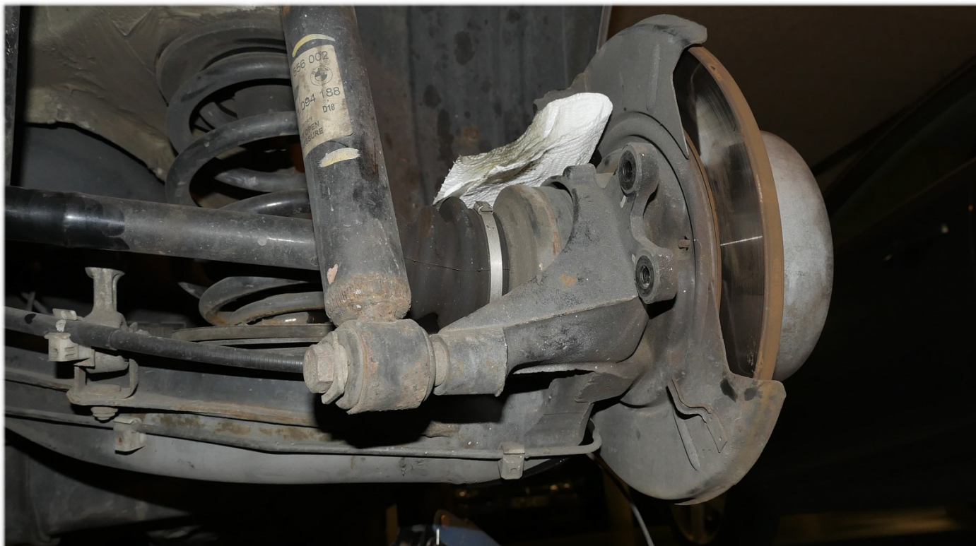
Bremssattelgehäuse abgenommen
