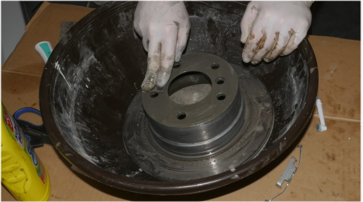
Anlagefläche reinigen
