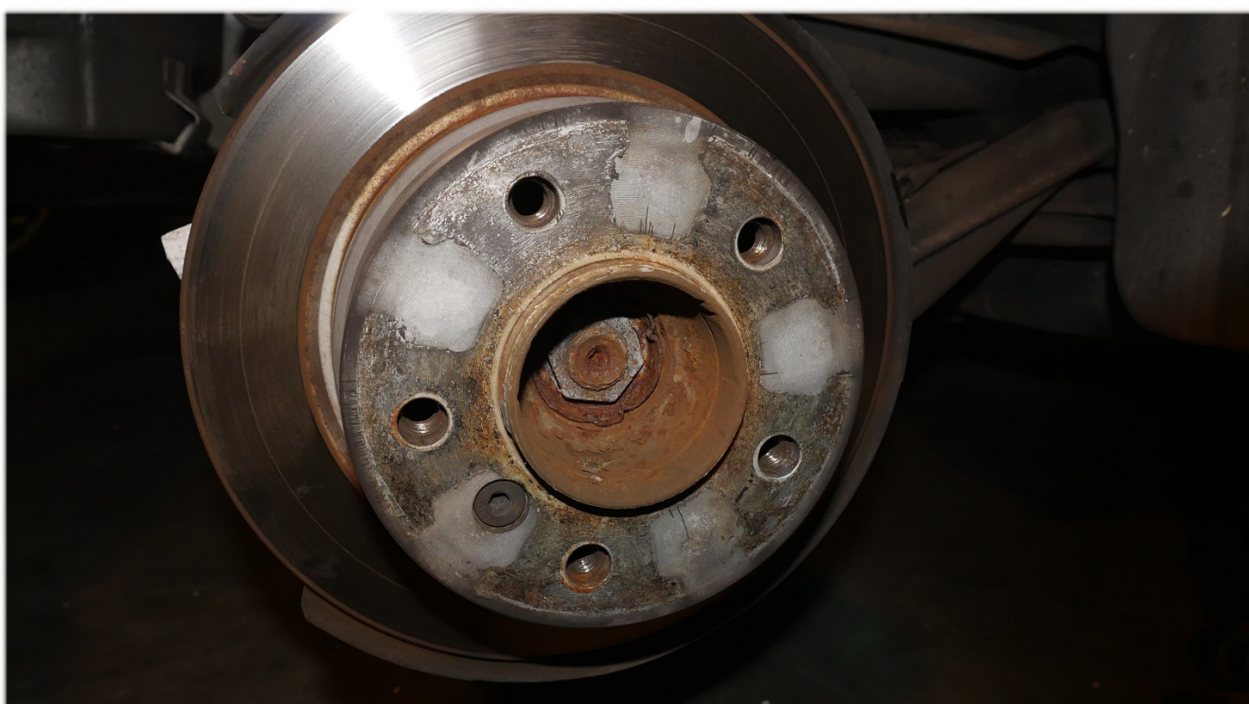
die Bremsscheibe, gesichert mit einer Innusschraube
