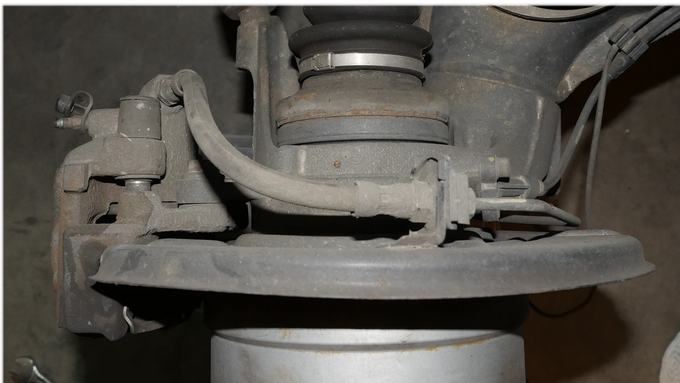
Bremsleitungsanschluß öffnen
