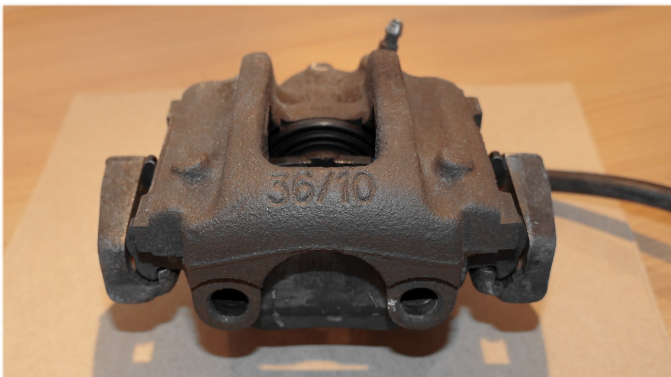
loser Rost ist entfernt
