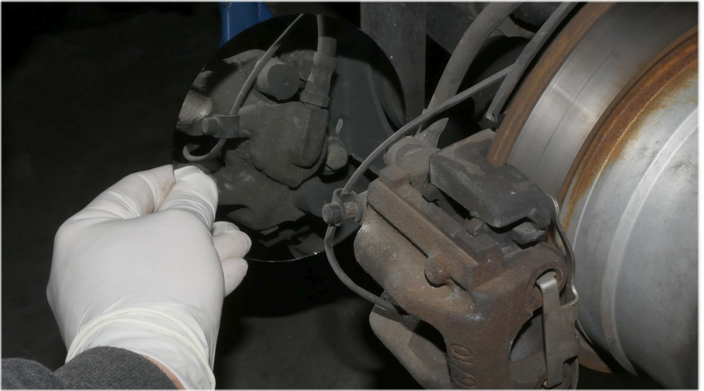
Anschlüsse von hinten mit einem Spiegel fotografiert
