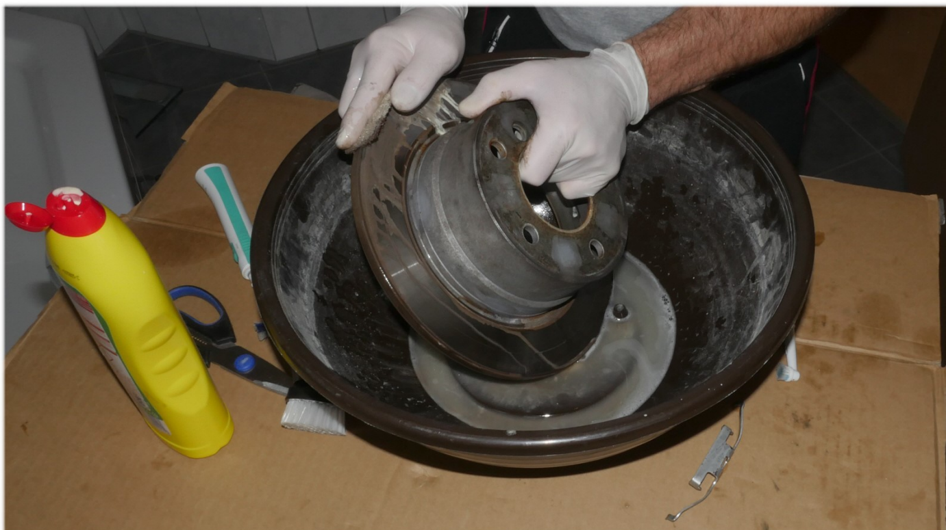
Rost an der Bremsscheibe mit Vliesband entfernen
