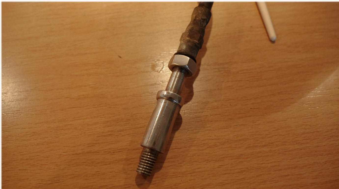
Bremsleitung mit einem M 10 x 1 Bolzen abgedichtet
