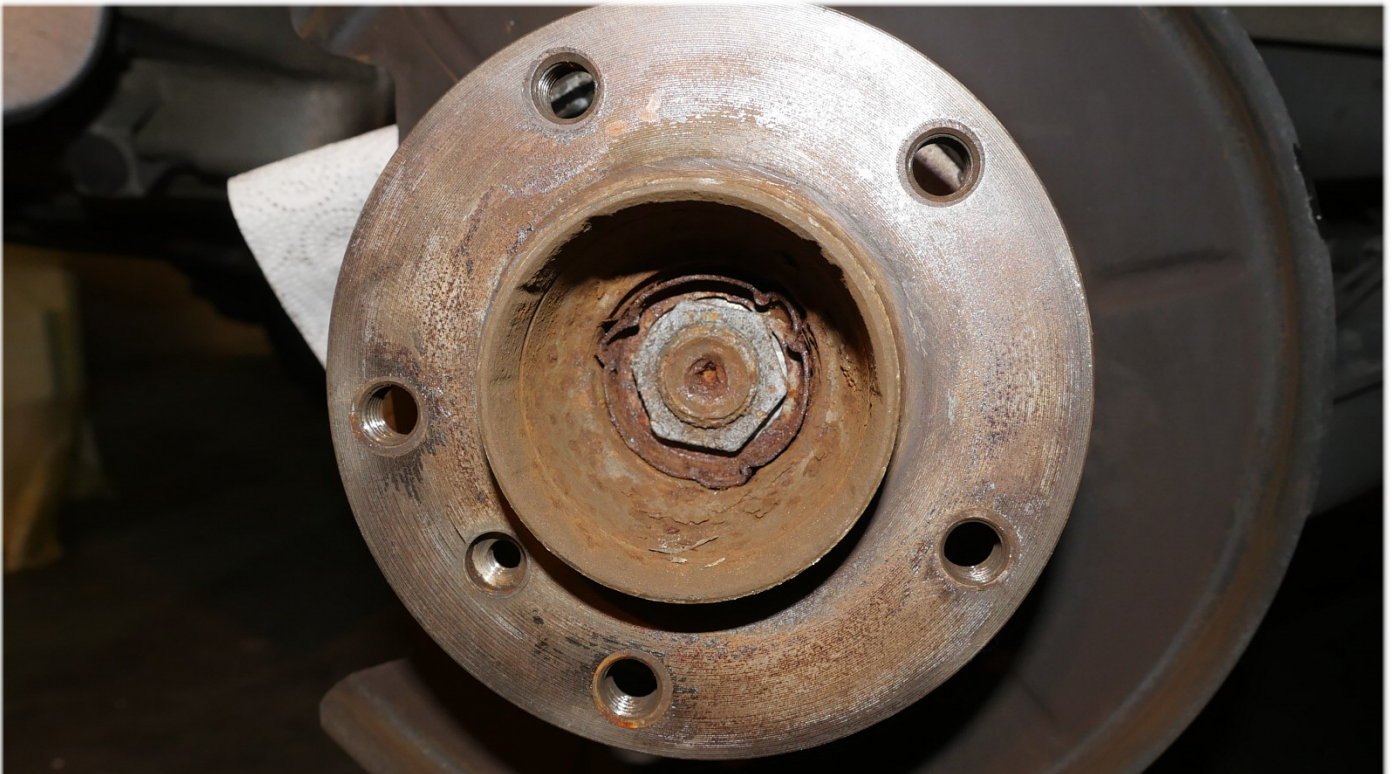
Bundmutter und Sicherungsblech sind auch oft rostig
