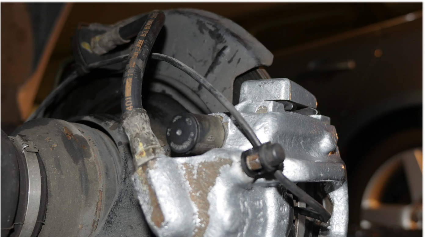
Bremsbelagfühler einbauen und Kabel verlegen, Staubkappe aufsetzen
