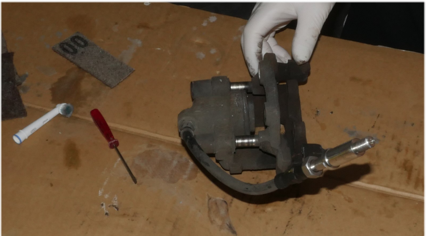
Bremsträger durch herausziehen der Führungsschrauben aus dem Bremssattelgehäuse ziehen
