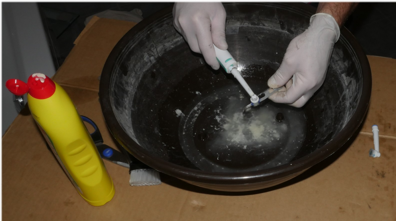
Haltefeder reinigen, geht mit einer elektrischen Zahnbürste und Scheuermilch gut
