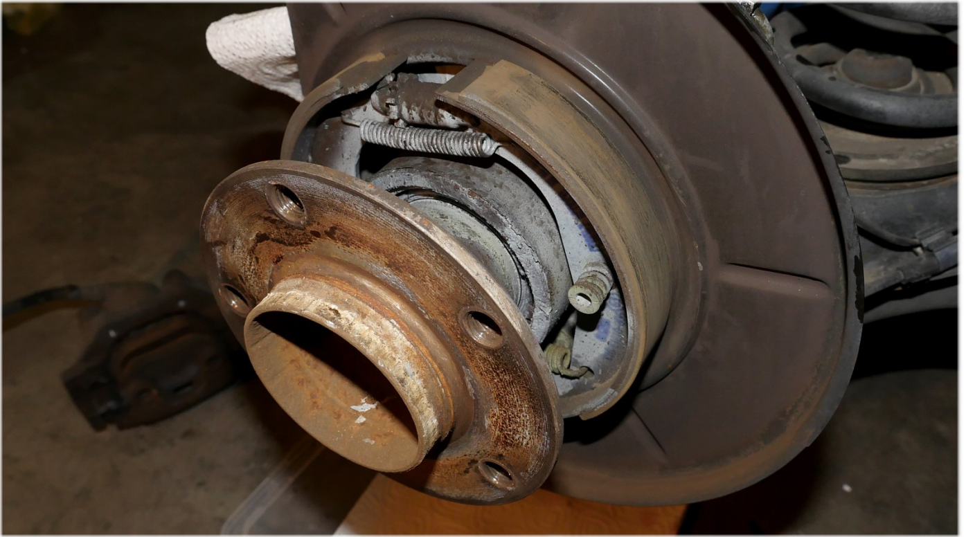
Radnabe rostig, hinten die Bremsbeläge der Handbremse ( Trommelbremse )
