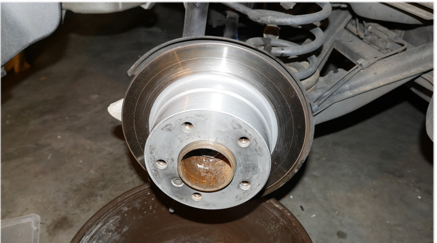
Bremsscheibe aufsetzen und Inbusschraube einschrauben
