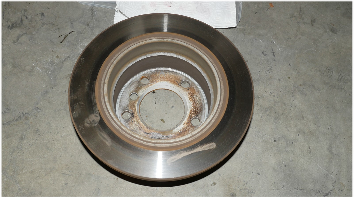
Inbusschraube lösen und Scheibe abnehmen
