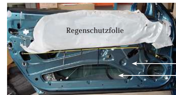
Abb.: Beispiel einer Fahrzeigtür - Dämmung mit Bitumenmatten / Teermatten
