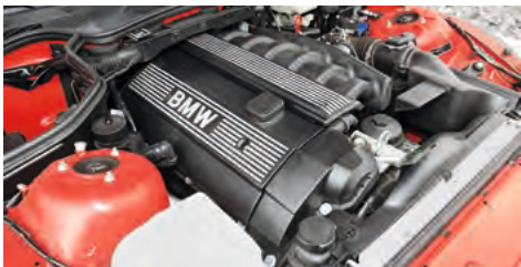
Der Reihensechszylinder ist ein Traummotor, egal ob mit 2,8 oder drei Litern Hubraum
