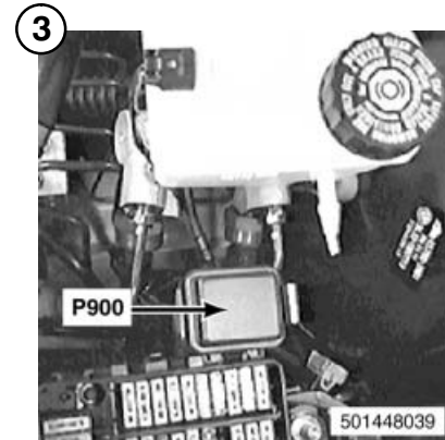
P900 Zusatzsicherungs- kasten
