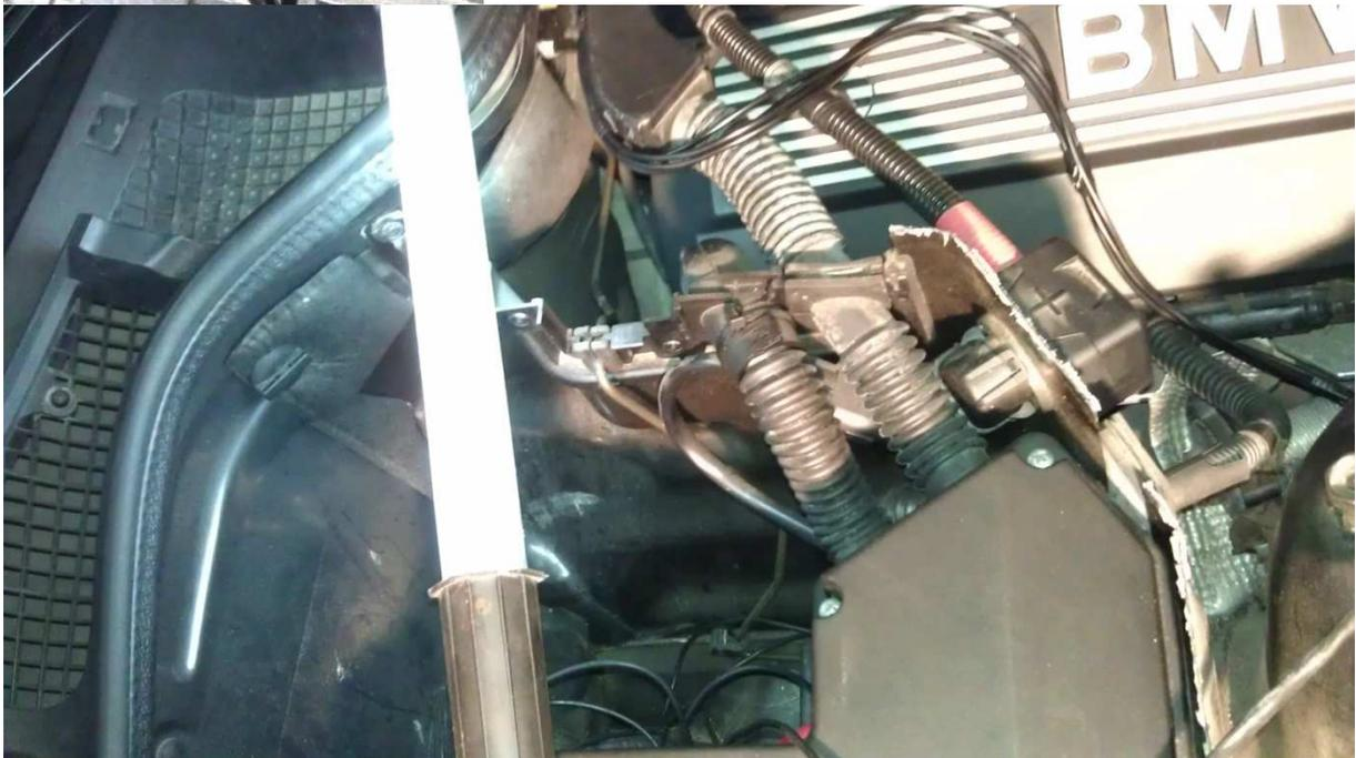
In diesem Schacht führt ein dünner Gummischlauch ins Fahrzeuginnere hinter das Handschuhfach. Durch diesen Schlauch habe ich meine Kabel gelegt.
