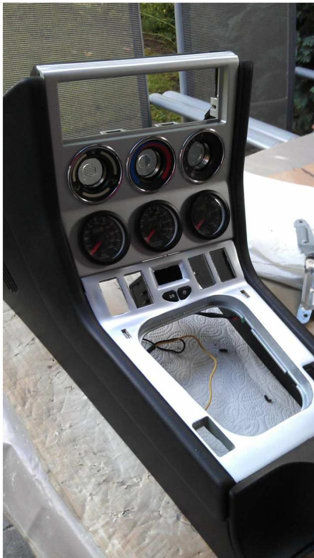
Die Schalter und der Radioschacht werden erst am Fahrzeug montiert wenn die komplette Mittelkonsole ihre endgültige Position eingenommen hat.
