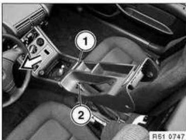
Das Ablagefach (1) schräg nach vorn schieben und vom Handbremshebel (2) ausfädeln.
