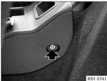
Schraube links/rechts lösen.
