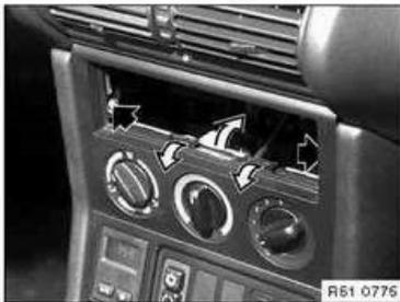
Schrauben links/rechts lösen.
