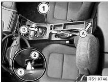
Ablagefach (1) hinten (A) etwas anheben und zugleich etwas nach hinten (B) ziehen, bis die Führungen (2) vorn ausgefädelt sind.
