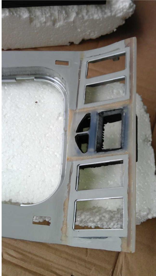
Beim Zusammenbau dreht man die neue Blende um und bestückt von hinten das Oberteil des Bordcomputers mit dem Display und der Tasterleiste. Zum Schluss wird das Unterteil des Bordcomputers einfach wieder aufgeklippt.
