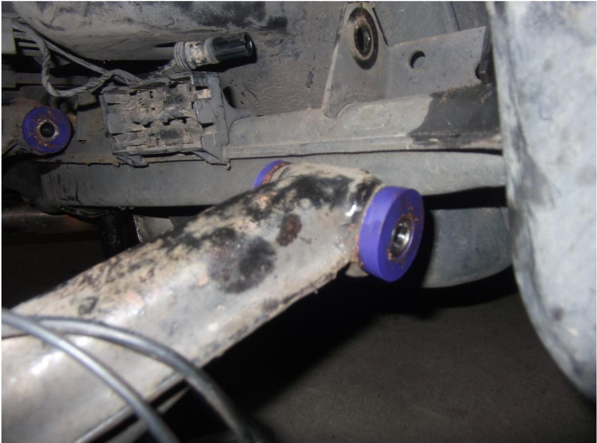
**Die Montage des Längslenkers erfolgt dann wieder in umgekehrter Reihenfolge.**
