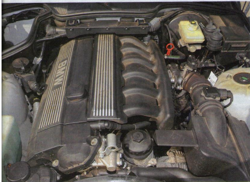
Der Sechszylinder passt saugend ins Motorabteil. Die 2,8- und 3,0-Liter-Aggregate gelten als problemlos und langlebig
